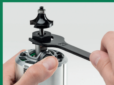
Spindellås för enkelt byte av fräsbit.
